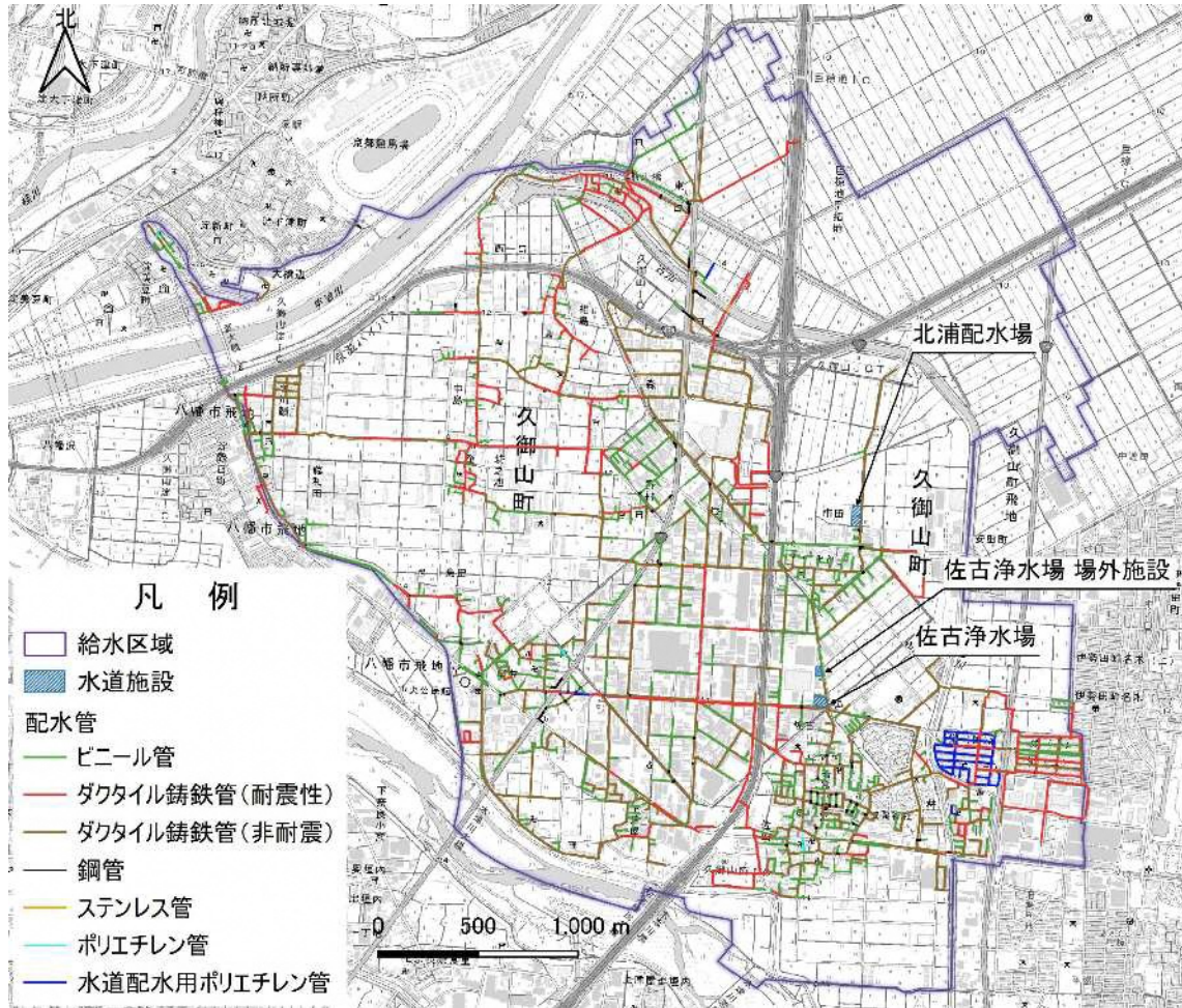
図 2.8 久御山町水道施設配置図 (令和 2 年度末)
